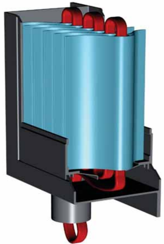
Figur ovenfor viser hvordan varmekabelen er rutet gjennom lameller og ut av drenstuss.
